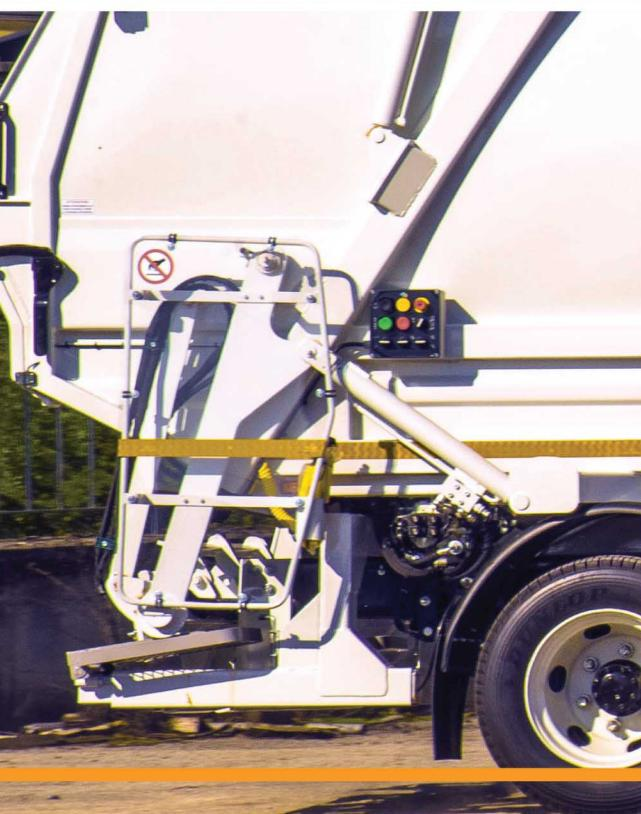
I MINICOMPATTATORI MINIMAC\_B e POCKET\_B sono realizzati con il criterio del **CASSONE MONOSCOCCA**, pertanto il sistema di compattazione è contenuto all'interno del cassone stesso. Il cassone ha una forma tale da costituire alla base un'unica vasca di raccolta.
